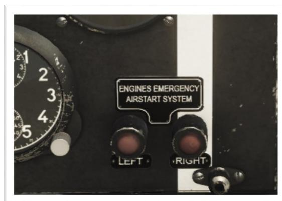
**ENGINE AIR RE-LIGHT SYSTEM LAMPS**
