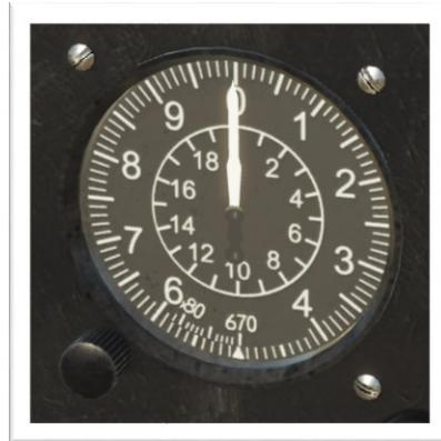
**VD-20 BAROMETRIC ALTIMETER**
